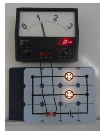
8.c ábra: A főágban folyó áramerőssége: I = 110 \text{ mA}
