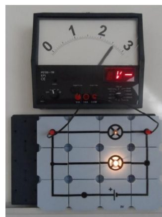
10.b ábra: Különböző fogyasztók kivezetései között mérhető feszültség: U = 2,6 \text{ V}
