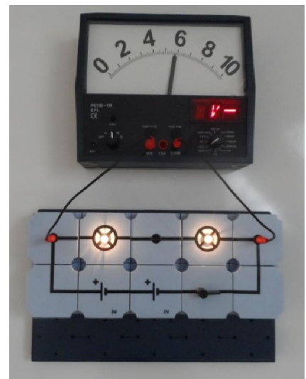
4.c ábra: Az áramforrás kivezetései között mérhető feszültség: U = 5,8 \text{ V}
