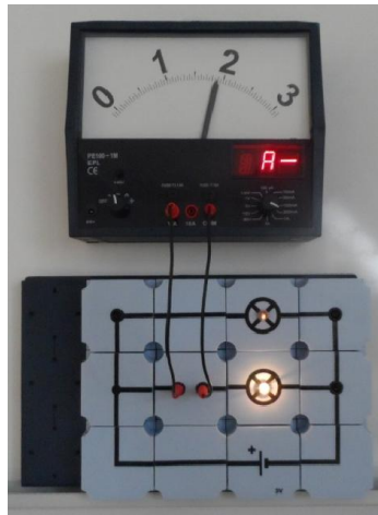
9.b ábra: A második fogyasztón átfolyó áram erőssége: I_2 = 190 \text{ mA}
