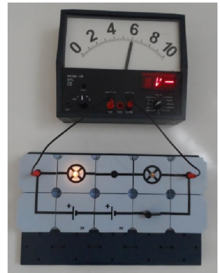
5.c ábra: Az áramforrás kivezetései között mérhető feszültség: U = 6 \text{ V}
