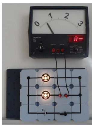
8.b ábra: A második fogyasztón átáramló áramerőssége: I_2 = 55 \text{ mA}
