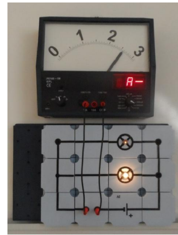
9.c ábra: A főágban folyó áram erőssége: I = 255 \text{ mA}
